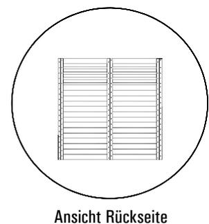
② ca. 7,85 lfm. Sichtschutz „Nizza“ Lärche kombiniert mit Rankgitter, auf Betonfundament aufgedübelt
