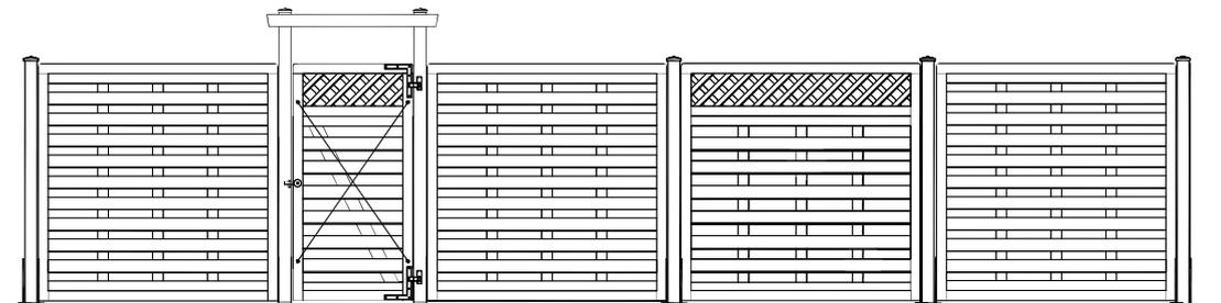
Sichtschutz Nizza, Kombielement Filzmoos und Eingangstor. Das Tor bestehend aus einem Holzelement, hinten und vorne stabilisiert durch diagonale Nirostreben und Beschlag Art.-Nr. 5255 inkl. Winkelbänder.
