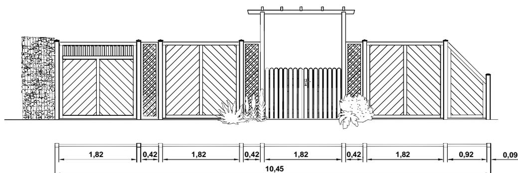
③ ca. 6,83 lfm. Sichtschutz „Filzmoos“ druckimprägniert auf Betonfundament aufgedübelt
