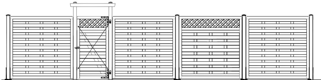
Sichtschutz Nizza, Kombielement Filzmoos und Eingangstor. Das Tor bestehend aus einem Holzelement, hinten und vorne stabilisiert durch diagonale Edelstahlstreben und Beschlag Art.-Nr. 5255 inkl. Winkelbänder.
