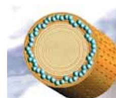
Fixieren: Im Vakuum-Fixierverfahren werden Holz und Schutzmittel untrennbar miteinander verbunden (keine Auswaschung).
