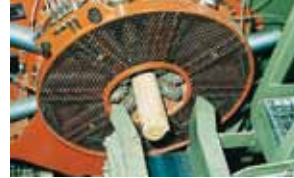
Bis zur Fertigstellung sind viele Arbeitsschritte notwendig z.B. Rundfräsung.
