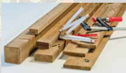
Kanthölzer, Pfosten, Latten und Bretter
