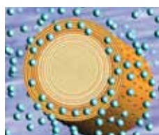
Imprägnieren: Die Kesseldruckimprägnierung bringt ein Maximum an Schutzmittel ein.
