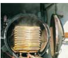
Fachgerechte Kesseldruckimprägnierung gewährleistet besten Holzschutz.
